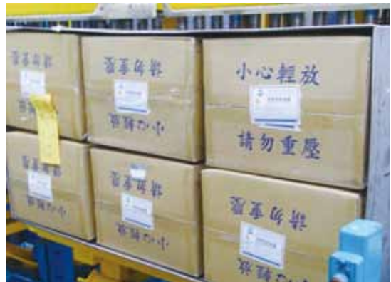
▲ 貨品裝載時，同時貼置劑量軟片，以偵測吸收劑量
